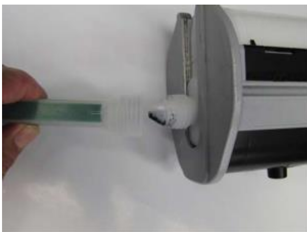
Рис. 4: Аккуратно установите, не повредив резьбу, статический смеситель на картридж
