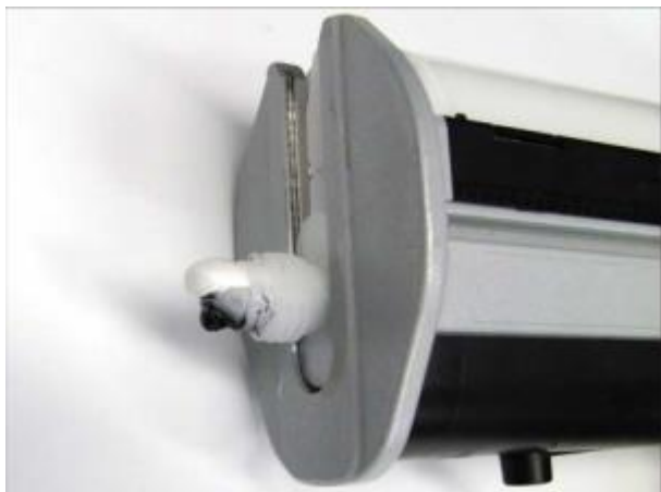
Рис. 3: Подготовка к установке статического смесителя
